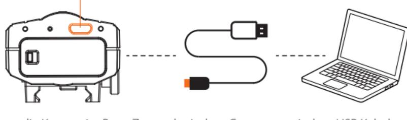
Wenn die Kamera im Boot-Zustand mit dem Computer mit dem USB Kabel verbunden ist, wird die Kamera als Wechseldatenträger erkannt.
