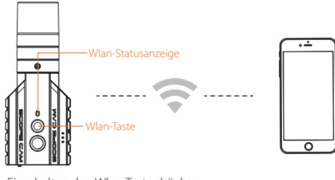
1. Nach dem Einschalten den Wlan-Taste drücken. Die Wlan-Statusanzeige des WLAN (blau) blinkt, sobald WLAN eingeschaltet ist und zur Verbindung bereit steht.
