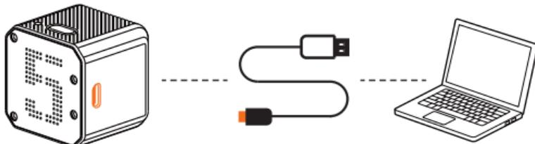
Nachdem Sie die Kamera eingeschaltet haben, schließen Sie sie über ein USB-Kabel an den Computer an, dann wird sie als Wechseldatenträger erkannt.
