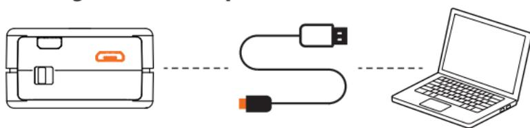
Wenn die Kamera im Boot-Zustand mit dem Computer mit dem USB Kabel verbunden ist, wird die Kamera als Wechseldatenträger erkannt.
