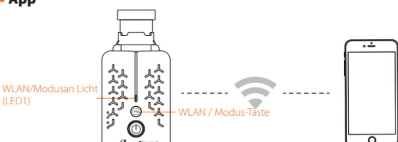
1. Nach dem Einschalten den WLAN/Modus-Taste drücken.
