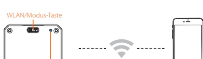
1. Nach dem Einschalten, drücken Sie die WLAN/Modus Taste, die WLAN-Statusanzeige (LED2 Blau) blinkt, bedeutet dies, dass das WLAN angeschaltet und bereit für die Verbindung ist.
