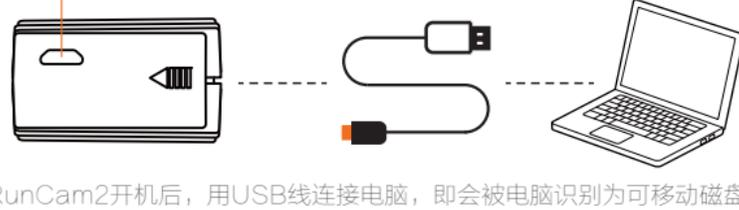
将RunCam2开机后，用USB线连接电脑，即会被电脑识别为可移动磁盘。
